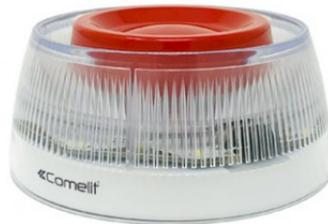
La sirena con lampeggiante indirizzata 41SCI000, con isolatore a bordo integrato, è alimentata dal loop ed è controllata dalla centrale per mezzo del protocollo di comunicazione. Per il montaggio è necessaria la base standard per i rilevatori indirizzati 41RBX020. Sirena adatta anche per installazioni in esterno, grazie all'utilizzo della base grado IP65 Art. 41BSE000. La sirena è inoltre dotata di isolatore integrato. Certificazione secondo EN54-3, EN 54-17, EN 54-23.
