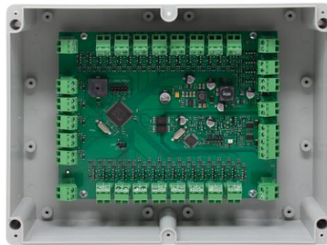
Modulo indirizzato con 32 uscite Open Collector. Destinato per la costruzione di pannelli sinottici. Il modulo viene installato su loop ed è alimentato esternamente. Integra uscite per la segnalazione dello stato della centrale (Allarme Incendio, Guasto, Esclusioni) ed ingressi per operazioni come: Tacitazione Sirene, Tacitazione Buzzer, Reset, Test e Blocco comandi. Alloggiato in box plastico grigio di dimensioni LxHxP (225x174x80). Certificazione secondo EN54-17 e EN54-18.
