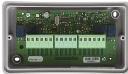
Il modulo indirizzato 41IOM004, con isolatore a bordo integrato, comanda quattro uscite a relè. E' alimentato dal loop ed è controllato dalla centrale per mezzo del protocollo di comunicazione. Il modulo viene fornito in un contenitore plastico adatto per il montaggio a parete dotato di coperchio trasparente per consentirne l'ispezione visiva in modo semplice. Certificazione secondo EN 54-17 e EN 54-18.
