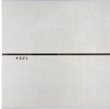
Modulo audio da incasso con montaggio filo muro e piastra in acciaio inox spessore 3 mm. Completo di art. 1682 per la gestione audio/serratura. Consente gestione segnalazioni visive per stato chiamata, conversazione e serratura. Dimensioni (LxHxP): 184x184x38 mm.
