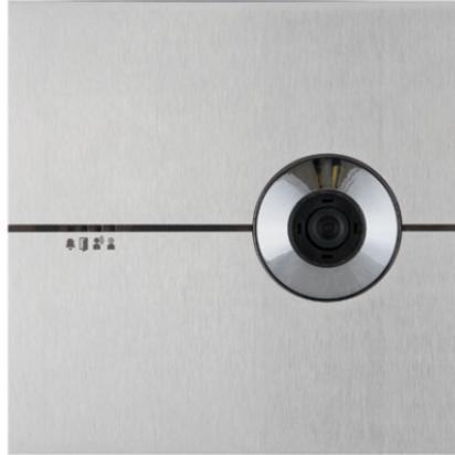
Modulo audio/video da incasso con montaggio filo muro e piastra in acciaio inox spessore 3 mm. Completo di art. 4682C per la gestione audio/video/serratura. Consente gestione segnalazioni visive per stato chiamata, conversazione e serratura. Dimensioni (LxHxP): 184x184x38 mm
