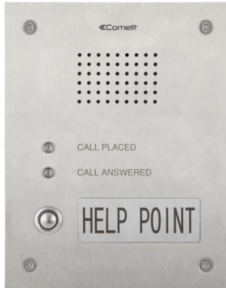
Pulsantiera in acciaio inox con singolo pulsante di chiamata e led di segnalazione per chiamata inoltrata e chiamata risposta. Completo di modulo audio POE per sistema ViP e di scatola da incasso. Modello "HELP POINT". Montabile da parete con accessorio art. 3461. Dimensioni 229x178x59mm.
