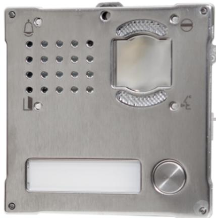
Modulo realizzato con doppia piastra di acciaio inox 316 da 2,5 mm. Da corredare con gruppo audio/video che dipende dal sistema di cablaggio utilizzato. Modulo 1 pulsante. Dimensioni 106x106x44 mm
