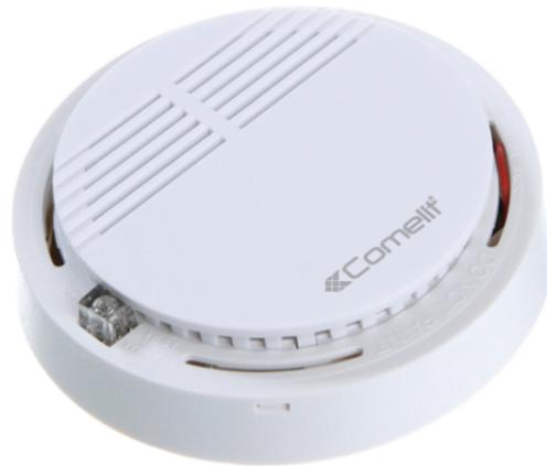
Rivelatore fotoelettrico di fumo da soffitto, area di rivelazione 20mq, alimentazione 12 VDC, consumo stand-by 300 microA, in allarme 30mA, contatto pulito tipo NO/NC, dimensioni  $\varnothing$  107x35 mm.
