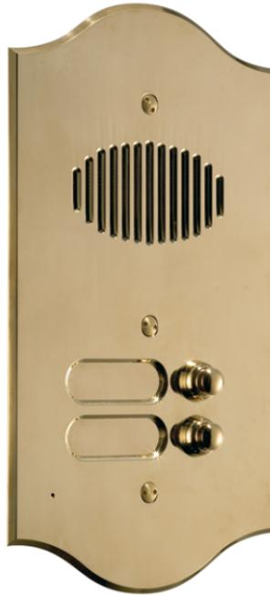
Pulsantiera citofonica con placca frontale realizzata da piastre in ottone da orologeria spessore 3 mm con trattamento in PVD. Completa di scatola da incasso e viti anti-intrusione. Tutte le pulsantiere sono corredate di portalampane (senza lampada) per lampade a siluro diametro mm 6,3 X 39. La pulsantiera va completata con il portiere citofonico che dipende dal tipo di cablaggio. 8 pulsanti, 2 file. Dimensioni piastra 180x316x3 mm. Dimensioni scatola 160x259x55 mm. 2 portalampane
