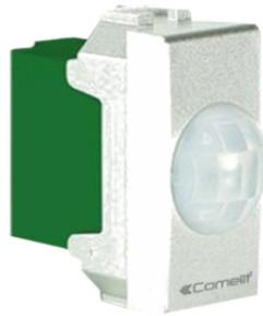
Sensore infrarosso passivo da incasso in scatola 3 moduli serie civile "Ave Lif." (nero). Portata 10 m. Angolo di copertura orizzontale 140°. Assorbimento max 9mA - 10-15 VC/C. Dimensioni: 1 modulo serie civile.
