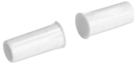
Contatto magnetico da incasso a sigaretta in materiale plastico, non adatto per il montaggio in infissi metallici. Colore bianco. Dimensioni: 21.5 x 10.5 x 9 mm.
