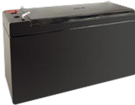
Batteria al piombo in tecnologia AGM. 12 VDC / 26Ah. Ogni singola cella della batteria è dotata di una valvola di sicurezza unidirezionale che garantisce lo smaltimento di eventuali sovrapressioni di gas interni. Dimensioni: 166x175x125 mm. Peso 8,1 kg.
