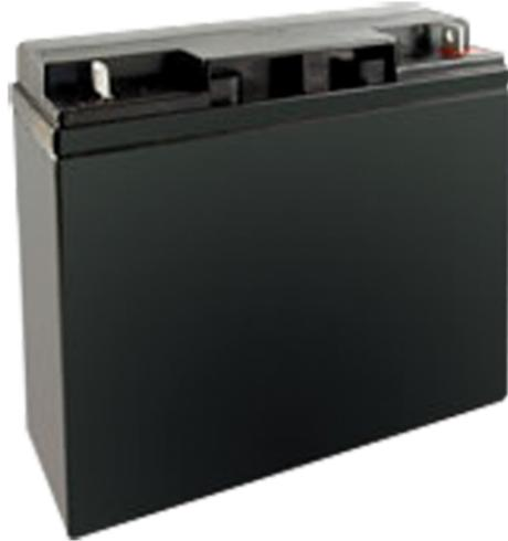
Batteria al piombo in tecnologia AGM. 12 VDC / 18Ah. Ogni singola cella della batteria è dotata di una valvola di sicurezza unidirezionale che garantisce lo smaltimento di eventuali sovrapressioni di gas interni. Dimensioni: 181x168x76 mm. Peso 5,5 kg.
