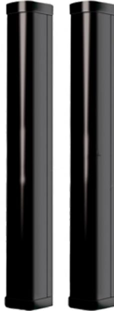
Coppia colonne a 36 raggi incrociati, portata massima 80 metri e portata minima 15 metri, altezza 3 metri, alimentazione 12 VDC assorbimento 80 mA RX, 80 mA TX, termostatazione 30 W a 24 Vac sia TX che RX, grado di protezione IP54, temperatura di funzionamento -25 a +65°C.
