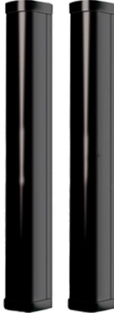
Coppia colonne a 16 raggi incrociati, portata massima 80 metri e portata minima 15 metri, altezza 1 metro, alimentazione 12 VDC assorbimento 30 mA RX, 50 mA TX, termostatazione 20 W a 24 Vac sia TX che RX, grado di protezione IP54, temperatura di funzionamento -25 a +65°C.
