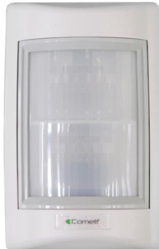
Doppio PIR lunga portata a duplice elemento da esterno in tecnologia ASIC che permette un'analisi accurata per eliminare falsi allarmi, alimentazione da 9.6 a 16 VDC, assorbimento a riposo 8 mA, in allarme 18 mA, portata 30.5 m con apertura 5 metri, temperatura di funzionamento da -25 a +55°C, protezione IP 65, uscita allarme e tamper NC.
