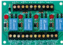
Scheda con 4 relè alimentati a 12 VDC, assorbimento 23 mA cadauno, uscite in scambio libero e selezionabili NC/NO indipendentemente, portata massima dei contatti 1A. Dimensioni: 77x55x20 mm.
