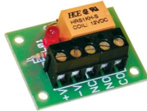
Scheda con 1 relè alimentato a 12 VDC, assorbimento 23mA, uscita in scambio libero e selezionabile NC/NO indipendentemente, portata massima del contatto 3A. Dimensioni: 40x31x20 mm.
