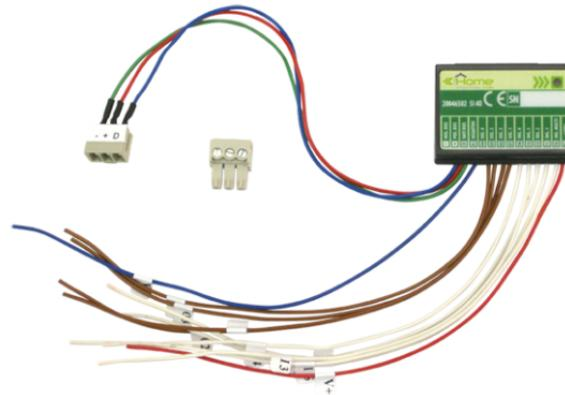
Modulo SimpleHome 5 ingressi digitali utilizzabili per collegare fino a 5 pulsanti (4 normali + 1 scenario) e 4 uscite transistor per collegare direttamente le spie di segnalazione a 24 Volt (max. 50 mA) o interfacce relé (ad es. 20046912, 20004692 e 20004603), dimensioni 41x29x9mm, da collegare al BUS SimpleHome. Assorbimento: 22mA. Assorbimento aggiuntivo per ogni uscita utilizzata: 50mA.
