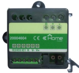
Interfaccia su BUS SimpleHome 3 ingressi di tipo impulsivo da collegare a contatori con uscita ad impulsi (es. acqua, gas, calorie) che in abbinamento ad un supervisore (ad es. Mini Touch o Planux Manager) consente la visualizzazione grafica dei consumi sottoforma di grafici o tabelle. Montaggio da incasso o guida DIN. Dimensioni 42x42x18mm (1 modulo DIN).
