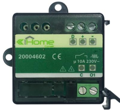
Interfaccia su bus SimpleHome con una uscita Relè 10A NO/NC configurabile. Montaggio da incasso o guida DIN. Dimensioni 42x42x18mm (1 modulo DIN). Assorbimento max: 20mA.
