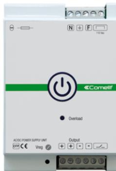
Alimentatore switching da fondo quadro. Tensione di ingresso 115/230VAC, uscita stabilizzata 24VDC. Corrente di uscita 10A. E' possibile l'installazione in parallelo di più alimentatori della stessa tipologia. E' dotato di un contatto pulito che permette di attivare un secondo alimentatore in caso di guasto oppure di attivare una segnalazione acustica o visiva. Contenitore in alluminio ed acciaio verniciato. Grado di protezione: IP20. Dimensioni (L x H x P): 75 x 112 x 132 mm.
