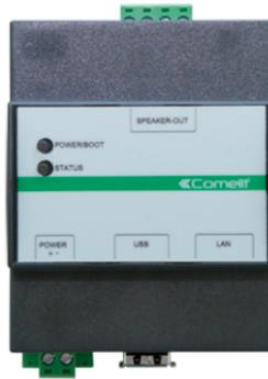
Player diffusione sonora su LAN con amplificatore, ingresso analogico per il collegamento di sorgenti esterne locali (no web radio, no applicazioni di terze parti), regolazione equalizzatore interna a scelta tra diversi livelli. Amplificatore di classe D.
