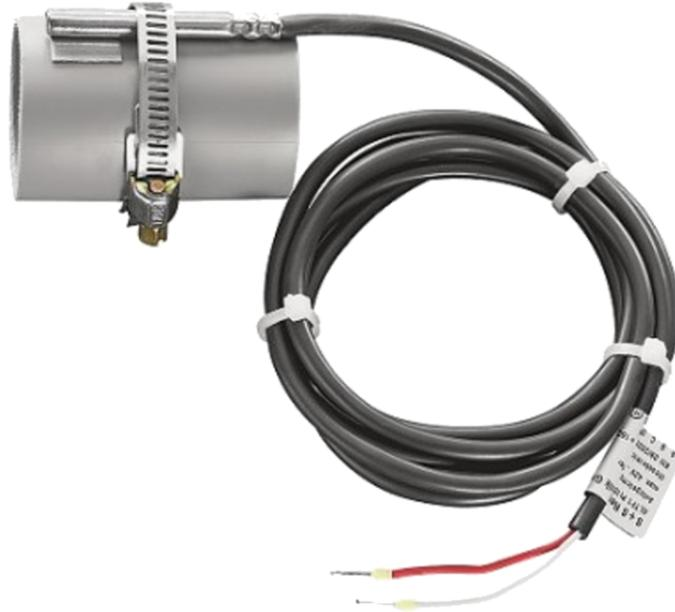
Sonda di temperatura a contatto per la misura di temperatura di tubazioni o contenitori, connessione diretta al modulo art. 20004140, grado di protezione IP65, range di misurazione da -25°C a +105°C, fissaggio tramite fascetta metallica in dotazione.
