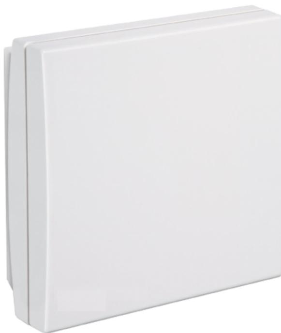
Sonda di temperatura PT100 per installazione a parete con fissaggio su scatola tonda o quadrata. Connessione diretta al modulo art. 20004140. Range di misurazione da -30°C a +90°C. Contenitore in ABS, colore bianco. Dimensioni (L x H x P): 85x91x27 mm.
