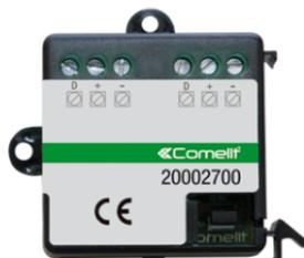
Modulo separatore/rigeneratore di BUS SimpleHome. Permette di isolare e rigenerare il bus su impianti con più di 40 moduli. Da collegare direttamente sul BUS SimpleHome creando isole di max 40 moduli. Possibilità di separare solo il BUS o anche l'alimentazione.
