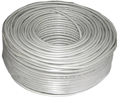
Cavo allarme schermato a 4 fili 2 x 0.5 + 2 x 0.22, classe di reazione al fuoco e tossicità secondo classificazione CPR EN 50575:2016 - CCA.
