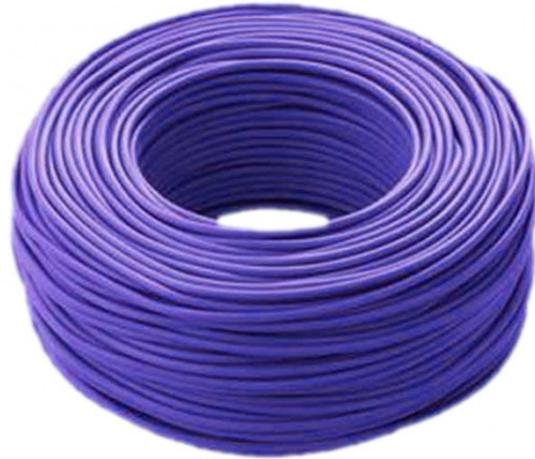
Cavo viola da utilizzare per la realizzazione di sistemi ad evacuazione vocale, con grado di resistenza al fuoco PH120, matassa da 100m, sezione fili 2 x 1,5mmq. Certificazione secondo norma EN 50575:2016.
