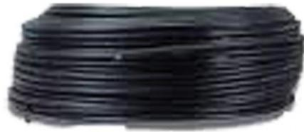
Cavo coassiale RG59 + 2 conduttori da 1mmq, impedenza 75ohm, schermo in rame, isolamento in polietilene, guaina in PVC, colore nero, adatto per tratte corte.
