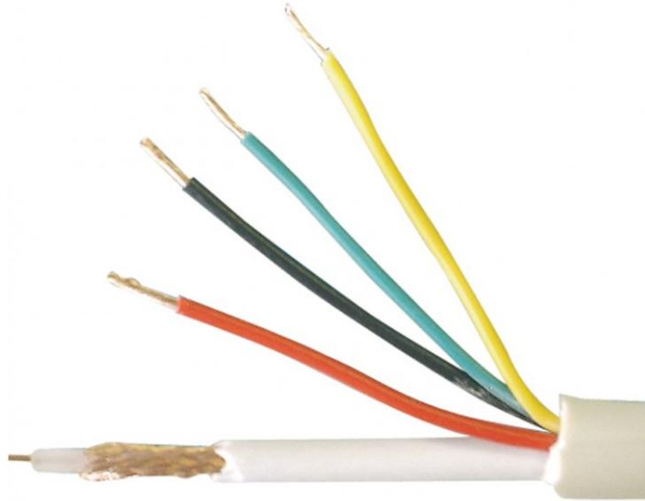
Cavo coassiale miniaturizzato + 4 conduttori (2 x 0,5 mmq, 2 x 0,25 mmq), impedenza 75 ohm, conduttore da 0,64 mm, schermo in rame, isolamento in polietilene cellulare, guaina in PVC, colore nero, adatto per tratte corte.
