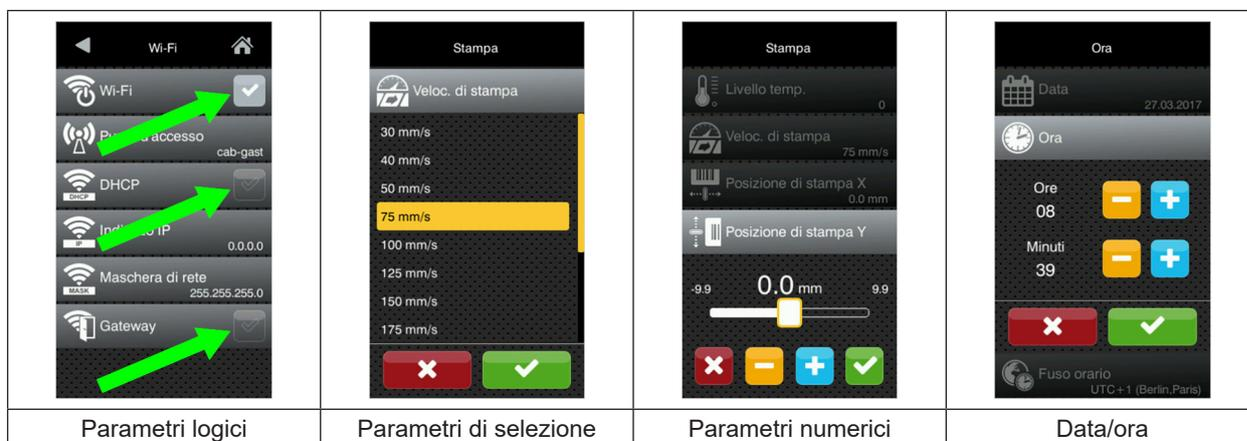
Figura 8 Esempi di impostazione dei parametri
