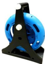
"The box" aspo verticale in plastica antiurto  $\varnothing$  320 mm girevole su cuscinetti a sfera su telaio verticale. Sulla spalletta del telaio è alloggiata la manopola per l'arresto della sonda. Sul manico sono ricavati gli alloggi per gli accessori d'uso forniti in dotazione. Da utilizzare per sonde da 10 a 30 metri.
