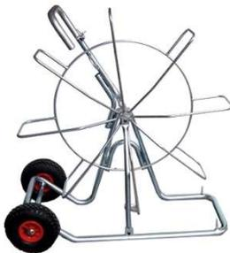
Aspo carrellato Ø 1000 mm su telaio verticale, in acciaio zincato con anello guidasonda, impugnatura per il trasporto e perni filettati M12 come sedi per l'alloggio degli accessori forniti in dotazione.
