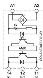
1 relè optoisolato 24Vdc transistor 2A a vite, estraibile
