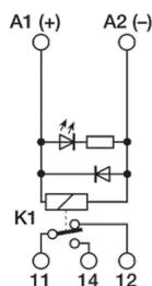
1 relè elettromeccanico 110Vdc 1.scambio
