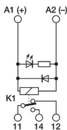
1 relè elettromeccanico 12Vdc 1.scambio
