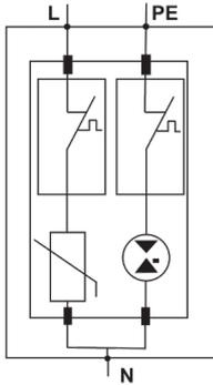
Limitatore di sovratensione AC, tipo II, tensione nominale: 220 - 230 V
