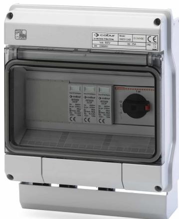
Centralino DC senza bobina di sgancio, 2 stringhe in ingresso, 1 uscite MPPT, 600 V
