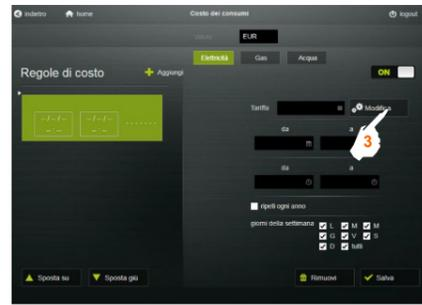
Per ciascun tipo di carico (Elettricità, Gas o Acqua), è possibile creare fino a 5 tariffe ciascuna con un diverso colore di visualizzazione e, ad ogni tariffa, possono essere assegnati fino a 5 valori di costo specificandone la data di validità.
