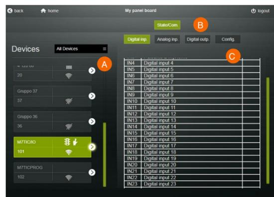
la sezione **A** mostra i Dispositivi configurati dall'utente con le caratteristiche e le icone di stato proprie di ciascun dispositivo.
