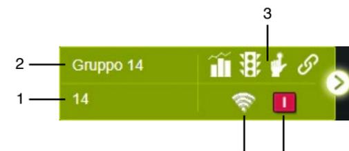
1. Indirizzo Modbus (Indirizzo Modbus - Posizione per contatori con uscite impulsivi o Indirizzo Modbus - Lato per le Stazioni di ricarica a "due-lati" della vecchia gamma o Indirizzo Modbus - Indicazione del tipo di dispositivo virtuale per la funzione Master/Slave)
