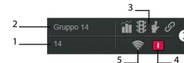
1. Indirizzo Modbus (Indirizzo Modbus - Posizione per contatori con uscita impulsi o Indirizzo Modbus - Indicazione del tipo di dispositivo virtuale per la funzione Master/Slave)
