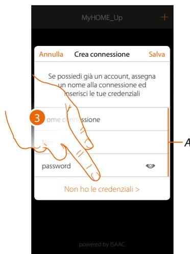
3. Tocca per creare la connessione ed accedere tramite rete locale con l'INSTALLER CODE
