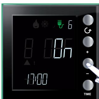
Per eliminare la condizione di forzatura del carico in anticipo rispetto alle 4 ore premi il tasto "-"
