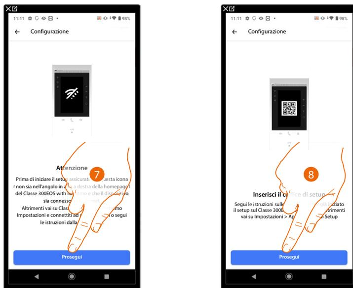
7. Verifica che il dispositivo sia collegato ad una **rete dati** con connessione ad internet e tocca per continuare
