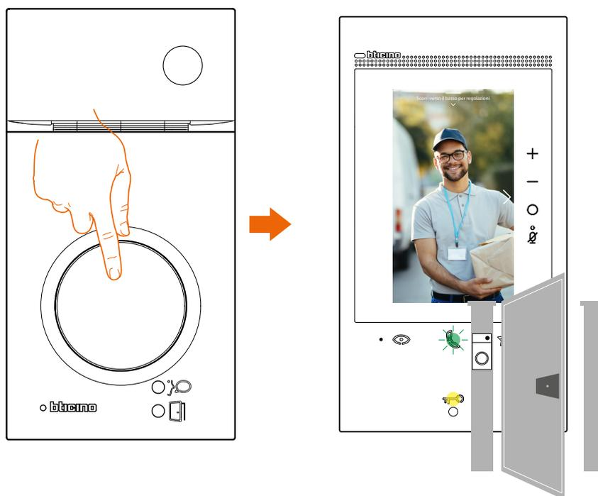
A seguito di una chiamata da Posto Esterno, viene visualizzata l'immagine ripresa dal posto esterno ed aperta in automatico la serratura
