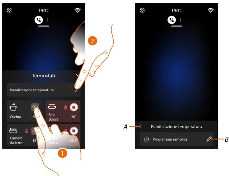
1. Tocca per forzare l'accensione della zona (BOOST) per un periodo limitato (30 minuti) indipendentemente dalla temperatura misurata o programmata. Una volta trascorso il tempo, il termostato riprenderà il funzionamento secondo la programmazione precedente.
