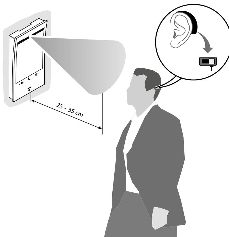
**NOTA:** La presenza di metallo ed il rumore di fondo generato da apparecchiature elettriche/elettroniche (es. computer), possono compromettere la qualità e le performance del dispositivo di accoppiamento.
