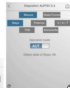
Toccare le due frecce nella parte inferiore della pagina per passare alla pagina con l'indicazione dello stato globale dei gradini (OK o guasto) ed il pulsante di comando AUTO/MAN utilizzato per visualizzare lo stato del regolatore e per commutare il dispositivo tra due modalità operative
