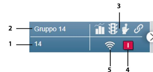
1. Indirizzo Modbus (Indirizzo Modbus - Posizione per contatori con uscita impulsi o Indirizzo Modbus - Indicazione del tipo di dispositivo virtuale per la funzione Master/Slave)
