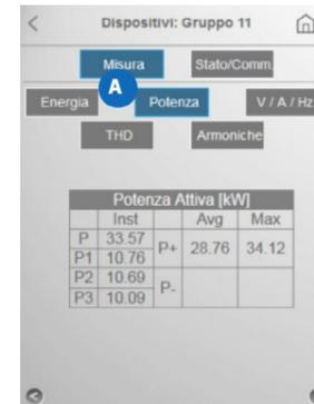
La pagina è divisa un due sezioni: la sezione A è l'area in cui è possibile selezionare due pagine: - Misura: visualizzazione delle misure effettuate da un dispositivo - Dispositivi di misura dell'Energia elettrica: Energia, Potenza, Tensioni / Correnti / Frequenza, THD (se disponibile), Armoniche (se disponibili)
