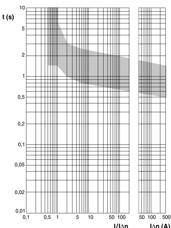
GL/GS déclenchement à 0,3 secondes -  $I_{\Delta n}$  0,3-1-3A
