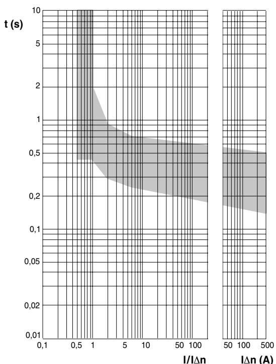
GL/GS déclenchement à 3 secondes -  $I_{\Delta n}$  0,3-1-3A
