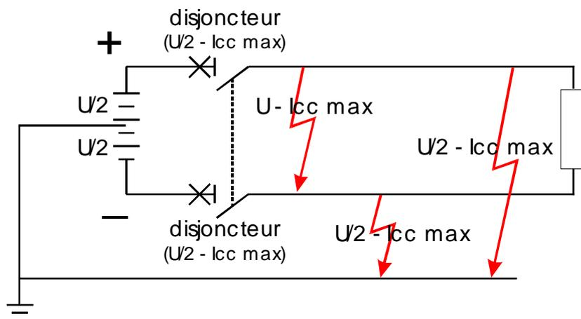
*Exemple : circuit relié à la terre par un point milieu /  $U = 180\ V\ DC$  /  $I_{cc} = 6\ kA$  /  $I_n = 10\ A$*
