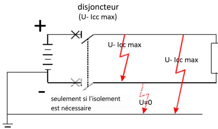
*Exemple : circuit relié à la terre par la polarité négative / U = 110 V DC / Icc = 10 kA / In = 32 A*
