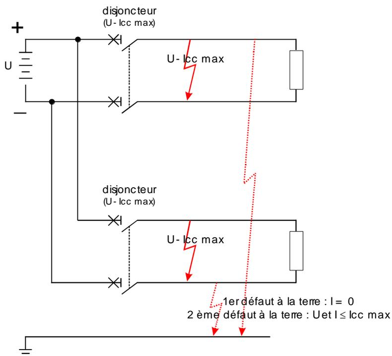
*Exemple : circuit isolé de la terre / U = 48 V DC / I<sub>cc</sub> = 6 kA / I<sub>n</sub> = 40 A*
