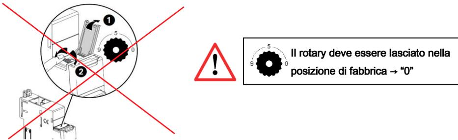
. Non è necessario assegnare fisicamente i moduli EMS BT DIN. Il **rotary deve essere lasciato nella posizione di fabbrica -> "0"**.
