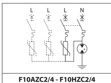
Limitatori di sovratensione con modalità di protezione L/N-PE e L-N (modalità di protezione comune e differenziale)
