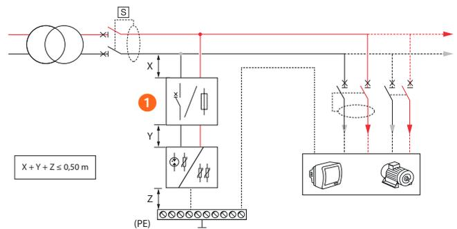
1 Dispositivo di protezione utilizzato con l'SPD (vedere 3.5.2)
