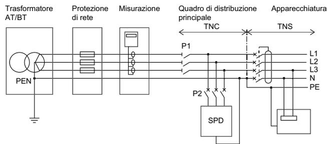
P1: dispositivo di protezione principale dell'impianto
