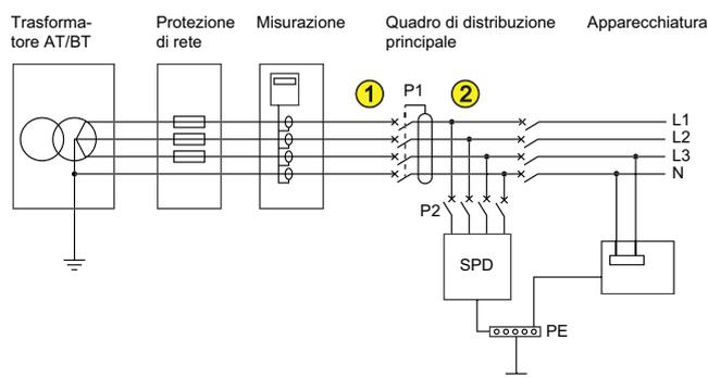
P1: dispositivo di protezione principale dell'impianto
