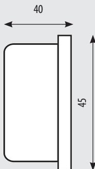
Le dimensioni sono espresse in millimetri. Dispositivo 2 moduli - serie civili.
