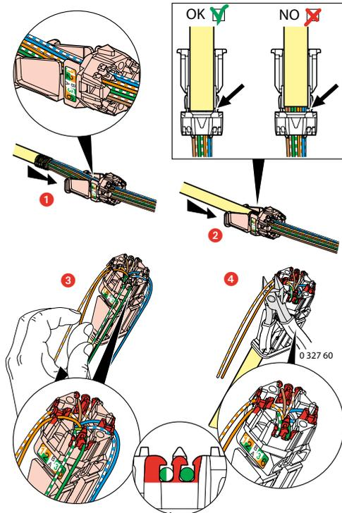
La separazione dei cavi e la posizione salda della guaina nel separatore assicurano che venga mantenuta la distanza prevista di 13 mm tra coppie, come richiesto dalle normative.
